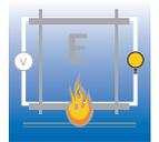
Der Begriff „Funktionserhalt“ steht für die Aufrechterhaltung der Stromversorgung für sicherheitsrelevante Einrichtungen im Falle eines Brandes. Dies sind z.B. Installationen für Not- und Fluchtwegbeleuchtung, Entrauchungssysteme oder Feuerwehraufzüge. Der Funktionserhalt sagt aus, wie lange eine Installation im Brandfall noch funktionieren muss. Die Aussage bezieht sich auf das Verhalten der gesamten Kabelanlage inklusive Kabel, Dose, Kabelführung und Befestigungsmaterial.
