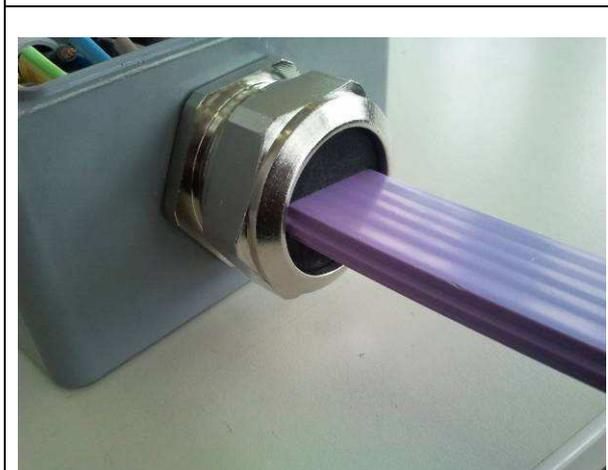
Überwurfmutter festschrauben bis das Flachkabel sauber abgedichtet ist.
