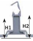
Schienenträger<br>12mm breit aus Polyamid 6.6 grau zum Aufschnappen auf Tragschiene nach EN60715TH35 oder zum Aufschrauben mittels zwei M4-Schrauben geeignet für alle drei Sammelschienen<br>Schienenträger hoch H1 35mm, H2 38mm<br>Schienenträger nieder H1 20mm, H2 23mm | <b>30956</b><br><b>30957</b>               | 158 975 107<br>158 975 007                | <b>30956</b><br><b>30957</b>               | 158 975 107<br>158 975 007                |               |                              |
