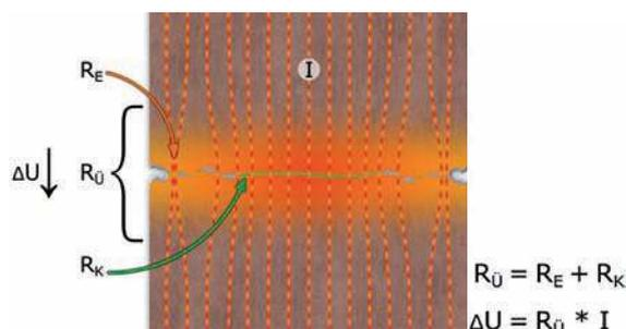
Kleinere Kontaktflächen bilden höhere Widerstandswerte, bei durchfliessendem Strom den sogenannten Spannungsabfall. Grössere Kontaktflächen, leichter deformierbare Teile oder höhere Kräfte, führen zu einem kleineren Spannungsabfall.
