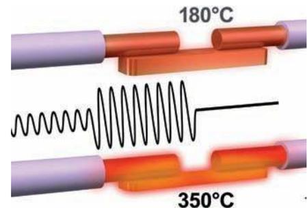
Im Kurzschlussfall (sehr kurze Zeit mit hoher Belastung) findet praktisch kein Wärmeaustausch statt. Die Energie (Wärme) wird zuerst von der Wärmekapazität der Metallteile aufgenommen.
