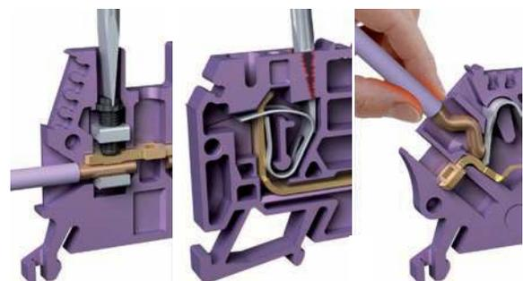
Während den Rüttelbewegungen wirken die Gegenkräfte auf die Klemmkraft. Bei federnden Elementen ist eine Bewegung und Entlastung möglich. Dadurch entstehen veränderliche Widerstände und Spannungsabfälle.
