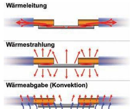
Im stationären Zustand, bei normaler Last oder Langzeit-Überbelastung, wird die Wärme von der Metalloberfläche an die Luft abgegeben. Die Fläche ist ausschlaggebend für die maximale Temperatur.
