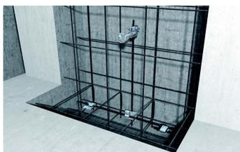
Averigüe qué medidas especiales hay que tomar cuando se utiliza un conductor colocado en una cimentación de hormigón, también conocido como banderillero.
