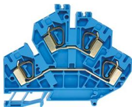
Blaue Doppelstock-Zugfederklemme DIN35 4mm<sup>2</sup> mit 2x2 Anschlüssen Bezeichnungsmöglichkeit seitlich und in der Mitte mit Streifen, für Querverbindung. versenkt
