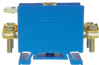
Neutralleitertrenner DIN35 50mm<sup>2</sup> 160A 83x26x46mm Ein- und Ausgang mit Doppelbriden
