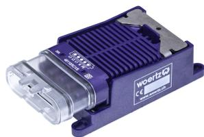
Boîte de sortie à raccordement rapide IP68 avec prise femelle à 5 pôles code1, occupation3L-N-PE, 250/400V 20A, pour
