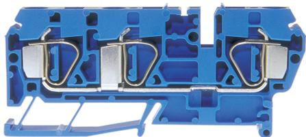
Borne à ressort DIN35 6mm<sup>2</sup> 88.5x8x35mm bleu avec 3 raccordements Possibilité de repérage sur le côté et au milieu avec bande, pour connexion transversale encastrée
