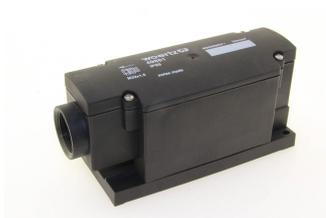
Boîte de jonction 5x10mm<sup>2</sup> capacité de conducteur: 2.5 à 10mm<sup>2</sup> IP66/68 sans halogène et avec protection anti-corrosive. Contact avec vis piercing et connexion de câble rond par 1 filetage de presse-étoupe M32x1.5
