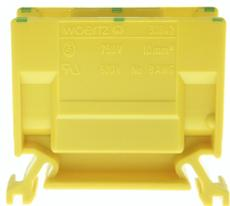
Abzweigklemme ohne Druckstück, Gewindestifte mit Schlitz, Metallteile Messing vernickelt, Spreizschuttschieber für Leiter durchgehend, 4-stellige Bezeichnungsmöglichkeit
