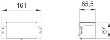
in lamiera d'acciaio zincata sendzimir per l'orientamento della presa in senso longitudinale
