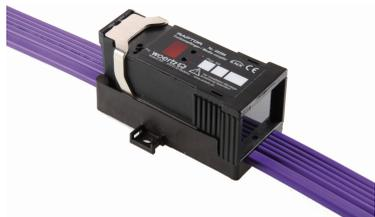
Raptor récepteur radio/coupleur de média - 868.3 MHz - 32 canaux - coupleur bus KNX intégré - IP20
