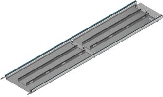
mit integrierter Nivellierung aus sendzimir-verzinktem Stahlblech 1.5mm beidseitig in Spezialaluminiumprofil Woertz eingepresst mit provisorischer Schutzkante in Nut eingelegt und Trittschalltrapezgummi als Deckelauflage
