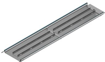
avec mise à niveau intégrée en tôle d'acier galvanisée sendzimir 1.5mm pressée des deux côtés dans un profilé spécial en aluminium Woertz avec bord de protection provisoire inséré dans la rainure et caoutchouc trapézoïdal anti-bruit comme support de couvercle vis hexagonales de mise à niveau M10x60 polyamide matériel d'assemblage inclus hauteur 50mm / largeur nominale du couvercle 400mm longueur : 2000mm
