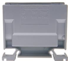
Borne de derivación sin pieza de empuje, tornillos prisioneros con ranura, piezas metálicas de latón niquelado, deslizador antidesplazamiento para conductores pasantes, opción de marcado de 4 dígitos
