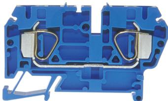
Zugfederklemme DIN35 4mm<sup>2</sup> 65.5x6x35mm blau mit 2 Anschlüssen Bezeichnungsmöglichkeit seitlich und in der Mitte mit Streifen, für Querverbindung versenkt
