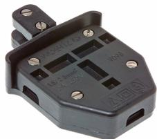
a cable de iluminación 2x1,5mm 2 o 2x2,5mm 2T ramificación sin cortar el cable de iluminación , ramificación directa con cable de iluminación mediante contacto de cuchilla
