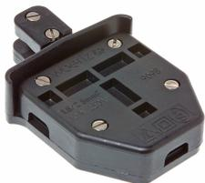
pour câble d'éclairage 2x1,5mm 2 ou 2x2,5mm 2T Dérivation sans couper le câble d'éclairage, dérivation directe avec câble d'éclairage via contact à couteau
