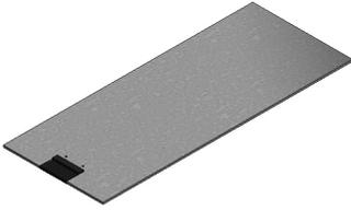
aus sendzimir-verzinktem Stahlblech 4mm Abmessung: 500x406mm mit Bürstenleisten als Kabelauslass, für 3mm Fertigbodenhöhe
