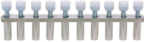
Isolierte Querverbindung 10-polig zu Klemmen DIN15/32/35 2.5mm<sup>2</sup>/4mm<sup>2</sup> inklusive Schrauben M3. Abmessung: 59.9x17.8 mm
