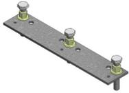
aus sendzimir-verzinkt Stahlblech Abmessungen: 260x50x4mm Mit 3 Nivelliersechskantschrauben M10x60 Polyamid und Blindnieten zur Befestigung an Kanalschale für zusätzliche Montage bei fehlender Abstützung.
