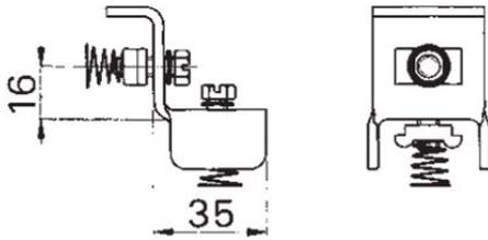
de chapa de acero de 3 mm, galvanizada con tornillos hexagonales ranurados de acero galvanizado M16x16, arandelas elásticas y tuercas ranuradas para insertar en el carril de perfil nº 4283, tipo C30 con 4 tornillos y 2 placas de anclaje de 50 mm de longitud
