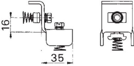
en tôle d'acier 3 mm, galvanisé avec vis à tête hexagonale fendue en acier galvanisé M16x16, rondelles élastiques et coulisseaux à insérer dans le rail profilé n° 4283, type C30 avec 4 vis et 2 plaques d'ancrage de 50 mm de long
