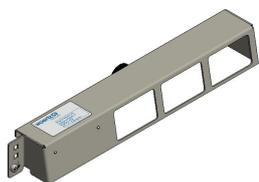
aus verzinktem Stahlblech 1.5mm mit Rändelschraube zur seitlichen Befestigung in der Kanalschale. Abmessung: 302x47(53)x40mm Farbe: RAL 7032 Kieselgrau bestückt: 1 Stk. Sacklochklemme 7x2.5mm <sup>2</sup> 10127
