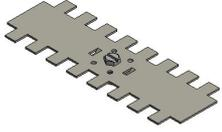
de chapa de acero de 1,5mm dimensión 170x60x19mm con tuerca ranurada y tornillo para montaje en carril de anclaje 29x15x2mm
