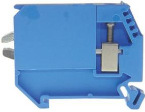
Neutralleiter-Trennklemme für Sammelschienenanschluss Sicherheitsabdeckung, für Sammelschiene 10x3 mm , 4-stellige Bezeichnungsmöglichkeit, Schraube M5
