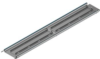
avec mise à niveau intégrée en tôle d'acier galvanisée sendzimir 1.5mm pressée des deux côtés dans un profilé spécial en aluminium Woertz avec bord de protection provisoire inséré dans la rainure et caoutchouc trapézoïdal anti-bruit comme support de couvercle vis hexagonales de mise à niveau M10x60 polyamide matériel d'assemblage inclus hauteur 50mm / largeur nominale du couvercle 300mm longueur : 2000mm
