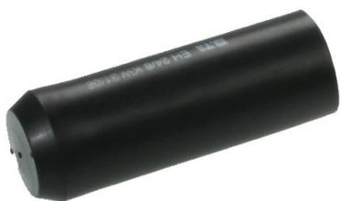
Embout thermorétractable, diamètre 24mm 8mm après rétractation, longueur 65mm , noir. Doté d'adhésif et de mastic d'étanchéité sur sa face interne.
