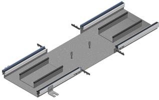
aus sendzimir-verzinktem Stahlblech 1.5mm beidseitig in Spezialaluminiumprofil Woertz eingepresst mit provisorischer Schutzkante in Nut eingelegt und Trittschalltrapezgummi als Deckelauflageinklusive Befestigungslaschen und Verbindungsmaterial Höhe 50mm / Deckelnennbreite 300mm Länge: 1000mm
