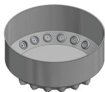
Avec 12 tubulures d'introduction Alésage Ø23
