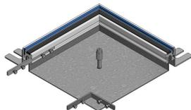
en tôle d'acier galvanisée senzimir 1.5mm avec arête de protection provisoire pour couvercle de largeur 200mm avec pattes de fixation et matériel de jonction
