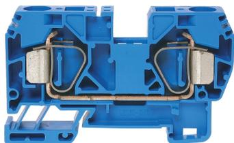
Zugfederklemme mit 2 Anschlüssen Bezeichnungsmöglichkeit seitlich und in der Mitte mit Streifen, für Querverbindung versenkt
