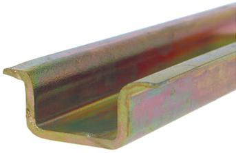
Tragschiene DIN35 mit 35x15x2.5 mm, aus Stahl galvanisch verzinkt, mit einem 50 mm<sup>2</sup> Kupferquerschnitt nach EN 60715, mit Längsloch, 2 m Länge.
