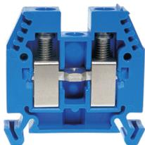
Bloc de jonction DIN35 16mm<sup>2</sup> 45x11x42mm bleu avec le meilleur contact possible, vis en acier inoxydable, possibilité de repérage à 4 chiffres des deux côtés, encastré pour les connexions transversales
