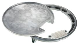
Cadre et couvercle en aluminium coulé sous pression avec bride de protection, pour revêtement de sol 5mm, avec 1 bac à câbles Art. n° 53961
