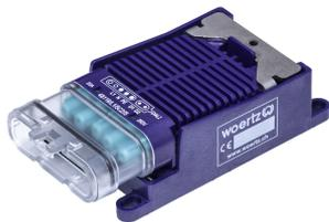
Schnellanschluss-Abgangsdose IP68 mit 5-Poliger Buchse Code2 (DALI), Belegung L1-N-PE-D1-D2, 250V 20A, für Flachkabel Art.49864/FRNC.
