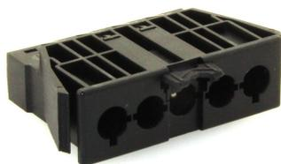
Gerätesteckanschluss zu Woertz-Stecksystem, Stecker schwarz, Code 1, 5-polig, verriegelbar. Wandstärke min.: 0,5 mm , Wandstärke max.: 1,2 mm . Geeignet für dreiphasigen Netzanschluss passend zu Woertz-Flachkabel-Installation.
