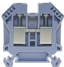
Bloc de jonction DIN35 10mm<sup>2</sup> 52x9x51mm gris avec le meilleur contact possible, vis en acier inoxydable, possibilité de repérage à 4 chiffres des deux côtés, encastré pour les connexions transversales
