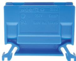
Borne de derivación sin pieza de empuje, tornillos prisioneros con ranura, piezas metálicas de latón niquelado, deslizador antidesplazamiento para conductores pasantes, opción de marcado de 4 dígitos
