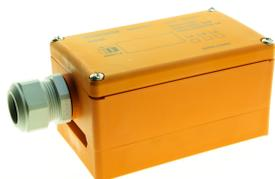
Cajas de seguridad contra incendios IP66/IP68, incl. prensaestopas, contacto de 2 tornillos, para derivación sin pelado, con conexión de tornillo para corriente pesada 5P 4mm 2 (6mm 2), longitudinal, rosca M25x1,5
