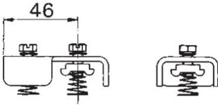
aus Stahlblech 3mm , verzinkt mit Sechskant-Schlitzschrauben aus Stahl verzinkt M16x16, Federringen und Nutensteine zum Einsetzen in Profilschiene Nr. 4283, Typ C30 mit 4 Schrauben und 2 Ankerplatten 50mm lang
