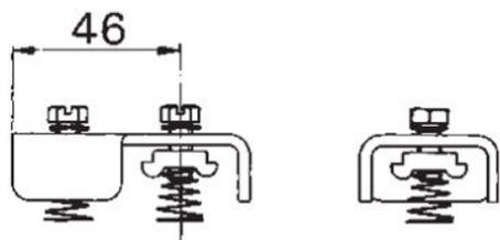
de chapa de acero de 3 mm, galvanizada con tornillos hexagonales ranurados de acero galvanizado M16x16, arandelas elásticas y tuercas ranuradas para insertar en el carril de perfil nº 4283, tipo C30 con 4 tornillos y 2 placas de anclaje de 50 mm de longitud
