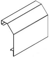
aus verzinktem Stahlblech 1.5mm
