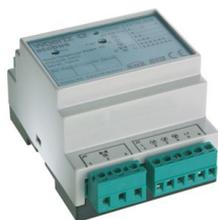
FanCoil-Regler, 24 VAC - kühlen, 1 x 24 VAC, , zu 2-Punkt (24-230 VAC) oder 3-Punkt Ventiltrieb (24 VAC) - dreistufiger Lüfter, 230 VAC - Binäreingang 1 x 24 VAC + Temp. lokal (3-poliges Sensor) oder extern (KNX) - KNX/EIB - IP20
