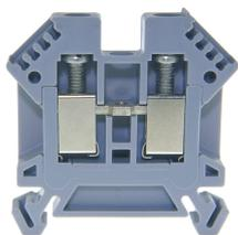
Bloque de terminales DIN35 6mm<sup>2</sup> 49x8x45mm gris con el mejor contacto posible, tornillos de acero inoxidable, opción de marcado de 4 dígitos en ambos lados, empotrado para conexiones cruzadas
