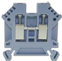
Reihenklemme DIN35 4mm<sup>2</sup> 49x6x45 mm grau mit bestmöglicher Kontaktierung, Schrauben aus rostfreiem Stahl, beidseitig 4-stellige Bezeichnungsmöglichkeit, für Querverbindungen versenkt
