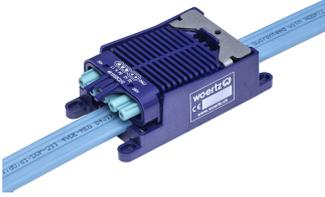
Ausgangsdose mit Schnellanschluss IP20/IP40, mit 5-poliger Buchse Code 2 (DALI), Belegung L-N-PE-D1-D2, 250V, 20A, für Flachkabel Art.48280.
