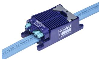
Caja de conexión rápida IP20/IP40, con toma de 5 polos código 2 (DALI), ocupación L-N-PE-D1-D2, 250V, 20A, para cable plano art.48280.
