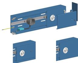
Canalina per parapetto 4670 182x85 mm - Con guida di ancoraggio stabile C30 per il fissaggio con dado per scanalature. - In lamiera d'acciaio zincata. Aperture sul davanti.
