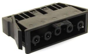
Raccordement d'appareil pour système de prise Woertz, douille, noir, code 1, 5 pôles, verrouillable. Épaisseur de paroi minimale : 0,5 mm, épaisseur de paroi maximale : 1,2 mm. Adapté pour raccordement au réseau triphasé en combinaison avec installation câble plat Woertz.
